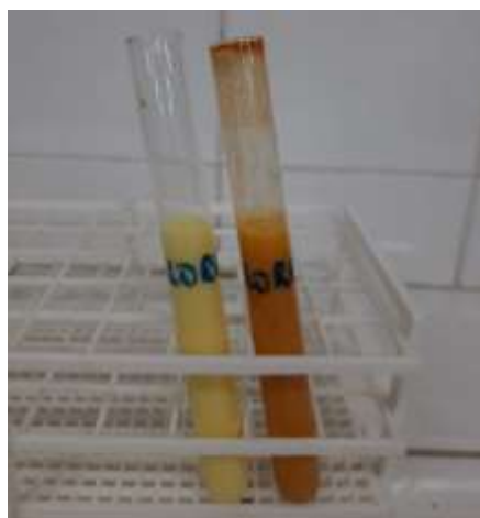
Figura 8: A esquerda é o leite com adição de cloreto e o da direita é o sem adição.
