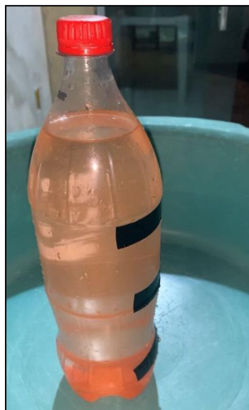
Figura 1 - Sistema experimental montado com garrafa PET perfurada e vedada.
