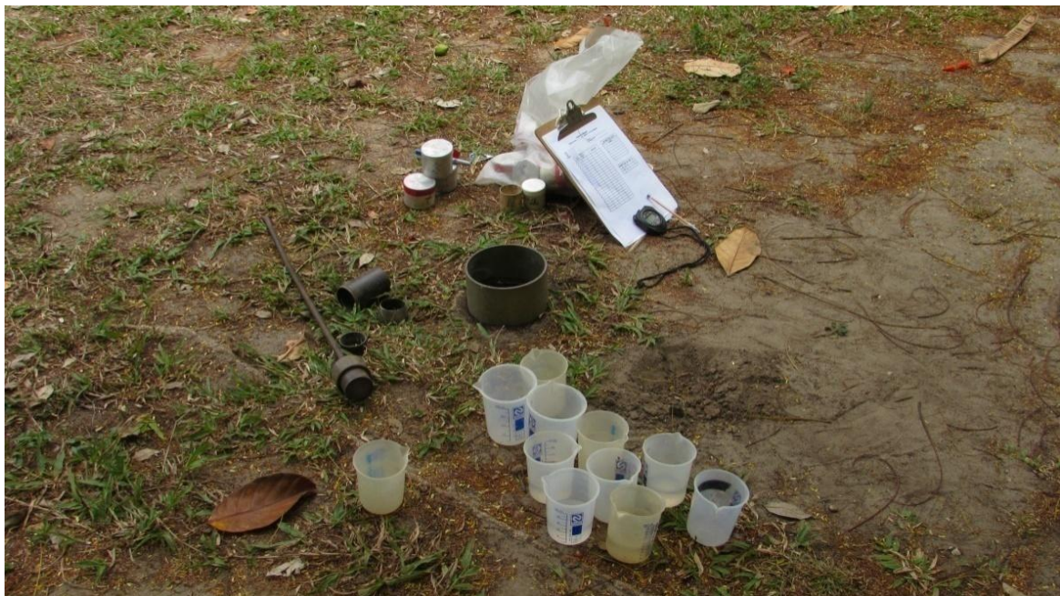
Figura 4 - Procedimento do ensaio de infiltração.
