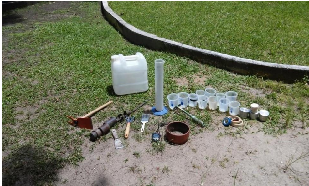
Figura 3 – Teste de infiltração tridimensional com infiltrômetro de anel simples (150 mm de diâmetro)
